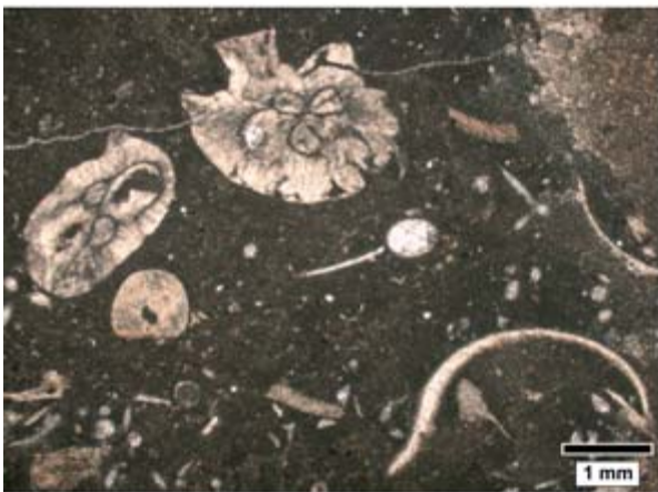
Abb. 127. Xanten, Colonia Ulpia Traiana. Rote belgische Kalksteine. Dünnschliffe. a) Nr. 490: Tabulate Koralle (Mitte, Alveolites?) und Krinoidenreste (am Rand rechts) in einer mikritischen Matrix. Im polarisierten Licht. b) Nr. 491: Tabulate Koralle (Thamnopora) mit dicken Wänden (oben links), Schnecke (unten rechts) und Krinoidenreste (Mitte rechts) in einer mikritischen Matrix. Rechts am Rand rekristallisierte calcitische Ader. Im polarisierten Licht. c) Nr. 1655: Reste von Korallen ( Senceliaepora tenuiramosa , oben links), Krinoiden- und Schalenfragmente in einer mikritischen Matrix. Im polarisierten Licht.
