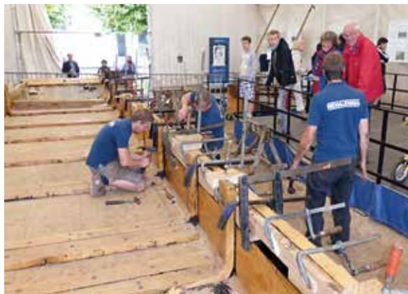
Abb. 58 Xanten, LVR-Archäologischer Park. Spanten und Bargholz werden mit Eisennägeln verbunden.
