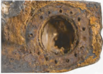
47 Gegenplatte 3.2, Abdruck von Buchse D und Löcher für den Vorstecker.
