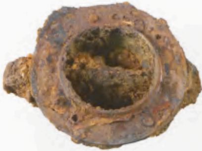
105 Spannbuchse D mit Spannbolzen D1 nach Abnahme vom Spannrahmen, Untersicht.
