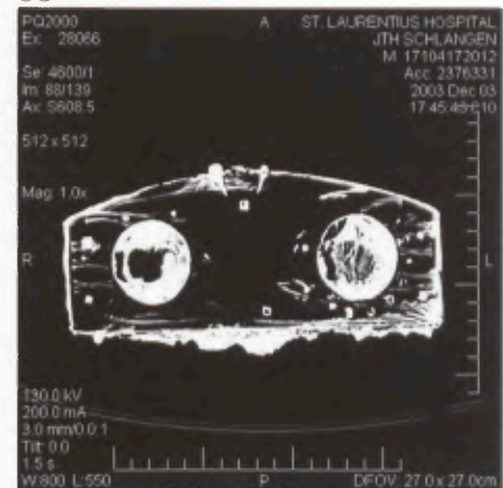
46 Querträger 4, Aufsicht, CT-Scans 95, 94 und 88 mit den Nägeln 4.5 (außen) und den Bolzen 4.4 (innen).
