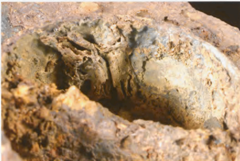
108 Spannbuchse D. Reste von organischem Material im Inneren.
