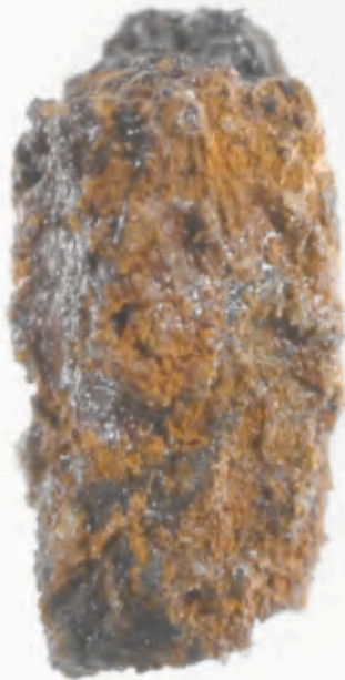
112 Spitze eines Vorsteckers für Spannbuchse D aus einem Holzfragment von Querträger 3.
