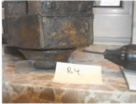
1 Probenentnahme an Buchse C.
