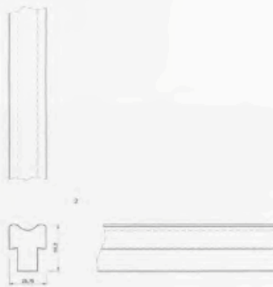
26 Schieber 2, Aufsicht, Querschnitt und Seitenansicht.
