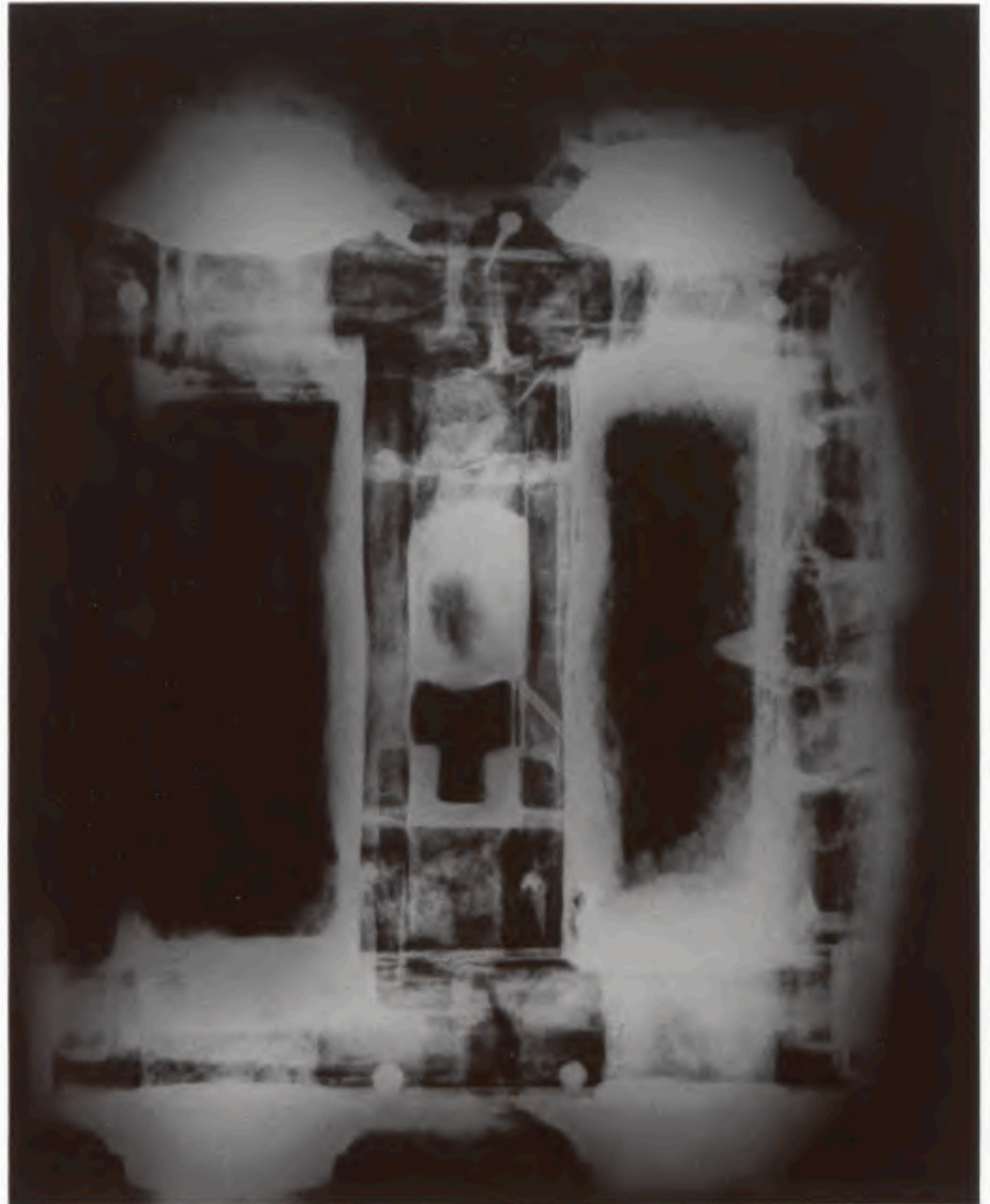
4 Spannrahmen des Torsionskatapults, Rückseite. Röntgenbild.
