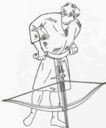
1 Spannweise des Gastrophetes, Rekonstruktion nach Heron.
