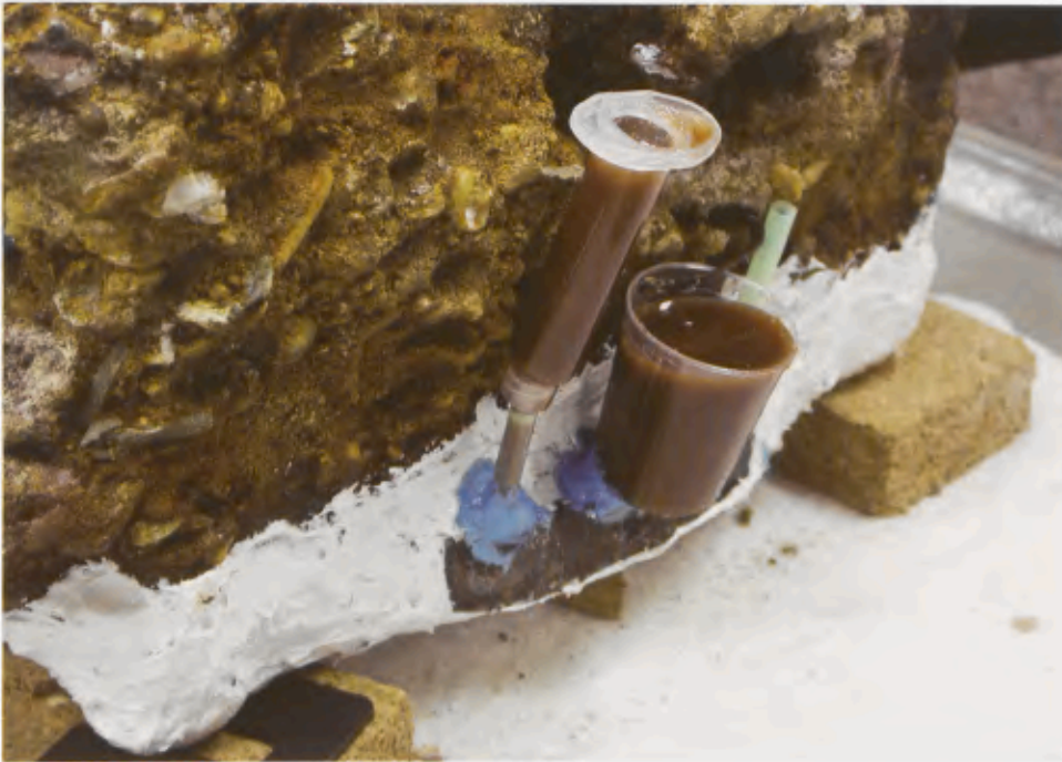
40 Gießzylinder und Entlüftungsvorrichtung nach dem Auffüllen.
