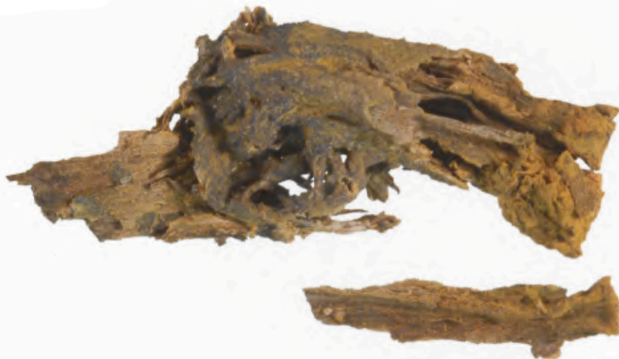
109 Organisches Material aus dem Inneren von Spannbuchse D.
