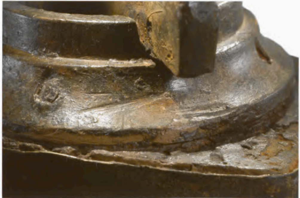
55 Spannbuchse A, Abnutzungsspuren auf der Hohlkehle.
