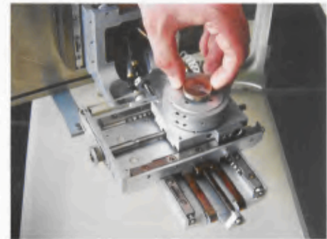
4 Platzierung der präparierten Probe auf Probenhalter.
