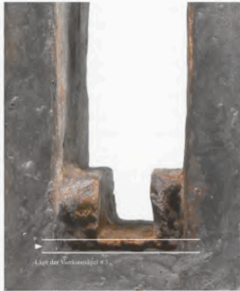
30 Frontplatte 12 und Lage der Vierkantnägel 8.3 (weiße Linie).
