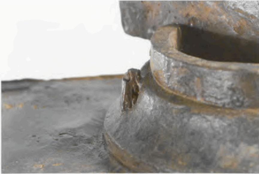
86 Spannbuchse A mit Rest eines Vorsteckers.
