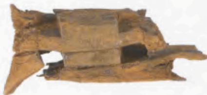
25 Holzreste von Querträger 3 mit den Löchern für den Vorstecker. Links die Aussparung für Spannbuchse D.
