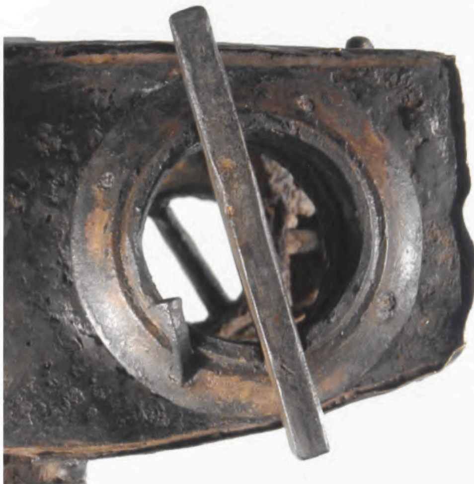
110 Spannbuchse D mit Spannbolzen D1 und Vorstecker D2 von oben.
