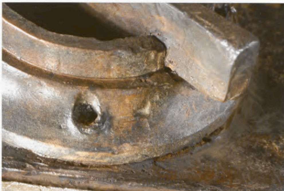
56 Spannbuchse A, Abnutzungsspuren auf der Hohlkehle.
