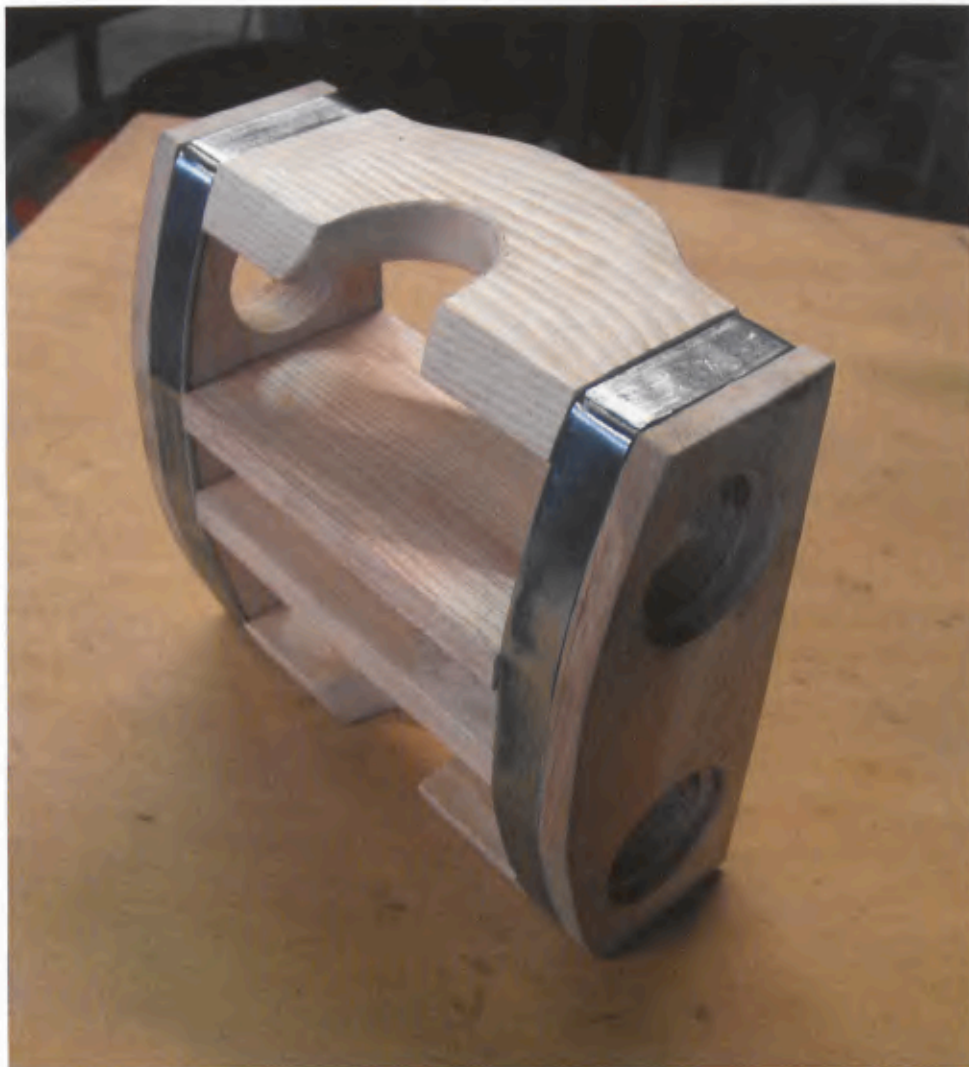
6 Der Spannrahmen während der Bauphase – besonders der Metallreifen als Verstärkung der Holzverbindung fällt auf.
