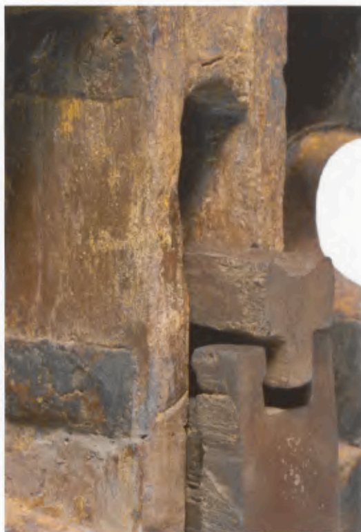
19 Spannrahmen, Rückseite. Detail des Mittelständers 7/8 mit Abguss von Pfeife 1 und Schieber 2. Abriebspuren.
