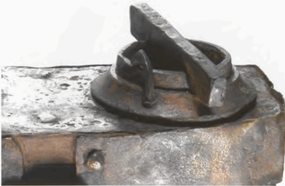
111 Spannbuchse D mit Spannbolzen D1 und Vorstecker D2.
