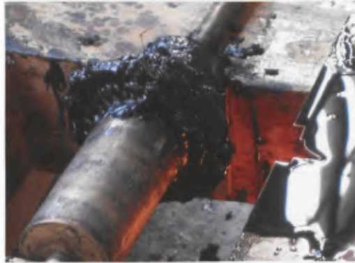
4 Aufbau des Wachskörpers auf dem Kern. Bevor dem Modell die Form verliehen werden kann, muss zunächst genügend Wachs aufgetragen werden.
