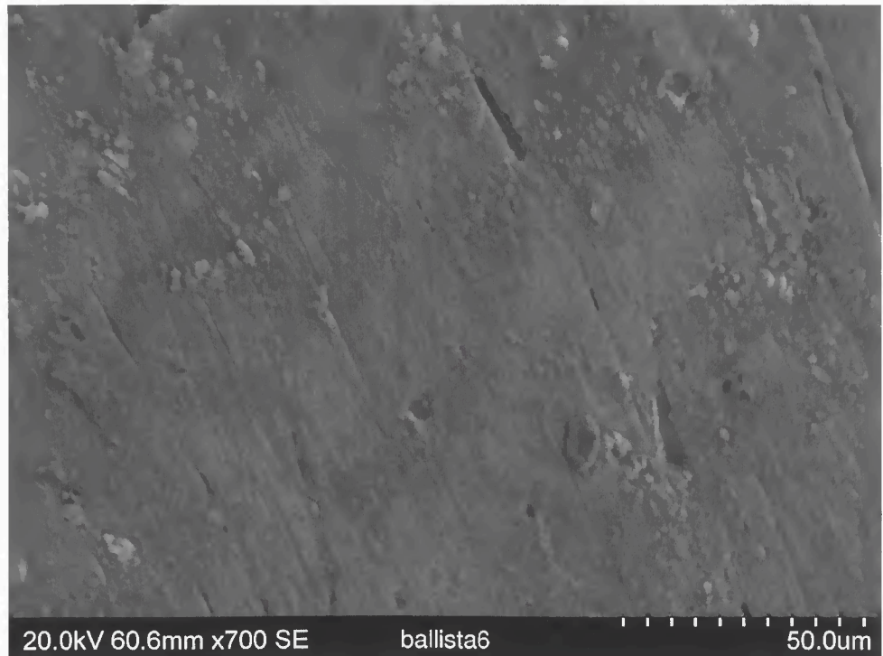
6 Drehrillen des Wachsdrehprozesses. Deutlich erkennbar sind die Spuren des Formmaterials, welches die Drehrillen überlagert.
