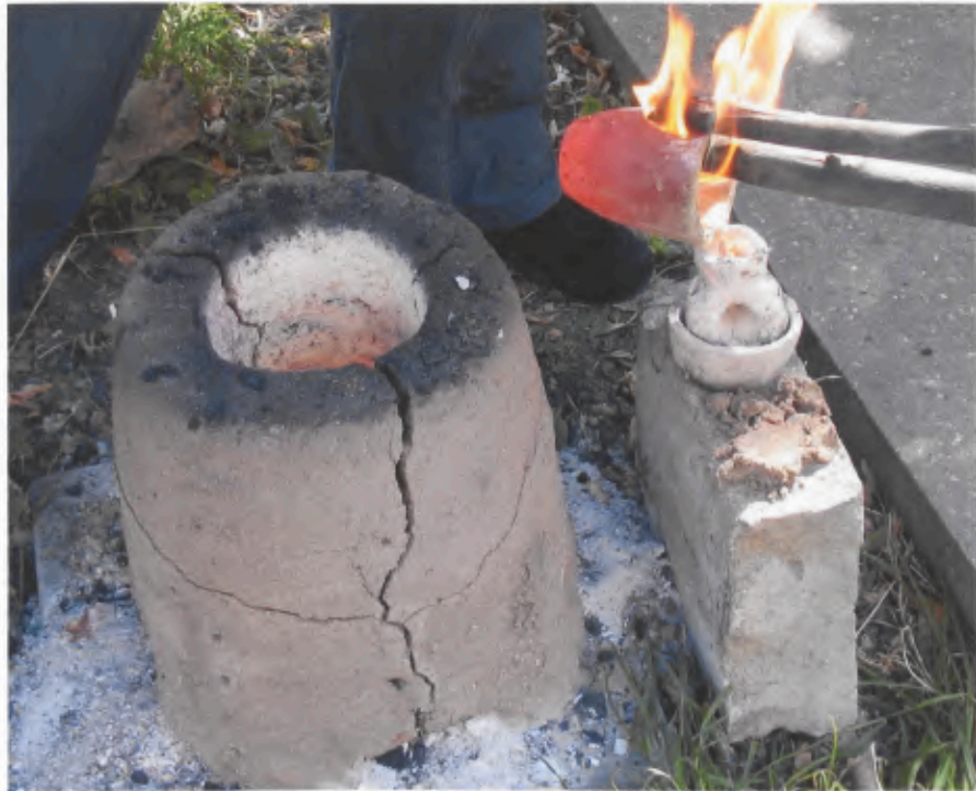
10 Gießen einer Messinglegierung in einem rekonstruierten, mit Holzkohle und natürlichem Zug betriebenen Ofen.
