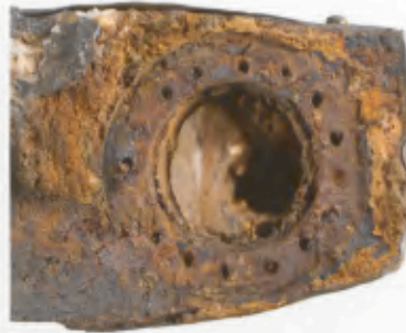
106 Spannrahmen nach Abnahme von Spannbuchse D. Gut erkennbar sind die 16 Löcher für den Vorstecker in Gegenplatte 3.2.
