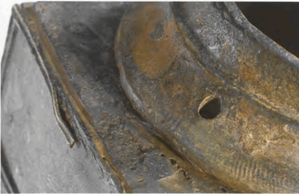
60 Spannbuchse C, Ratterspuren vom Abdrehvorgang und Erscheinungsbild des Loches für den Vorstecker.
