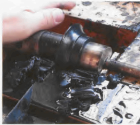
3 Mit Hilfe der heißen Metallschablone wird dem Wachs das gewünschte Profil der Buchse verliehen.
