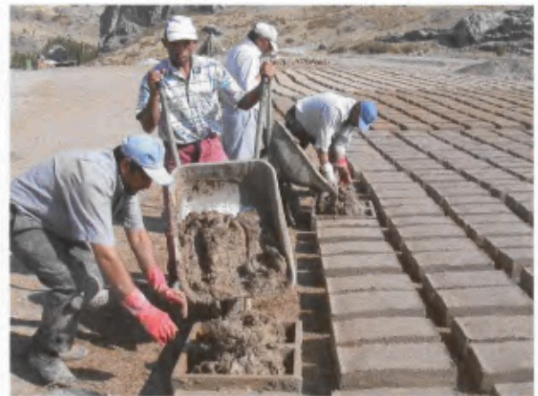
10 Herstellung von Halbziegeln mit Hilfe von in hölzernen Rahmen.
