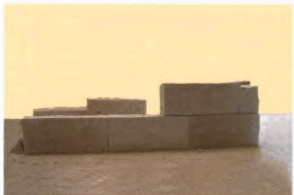
14 Versetzter Quader, erkennbar die schmalen Fugen durch Übertragung des Oberlagers auf den unteren Randschlag.
