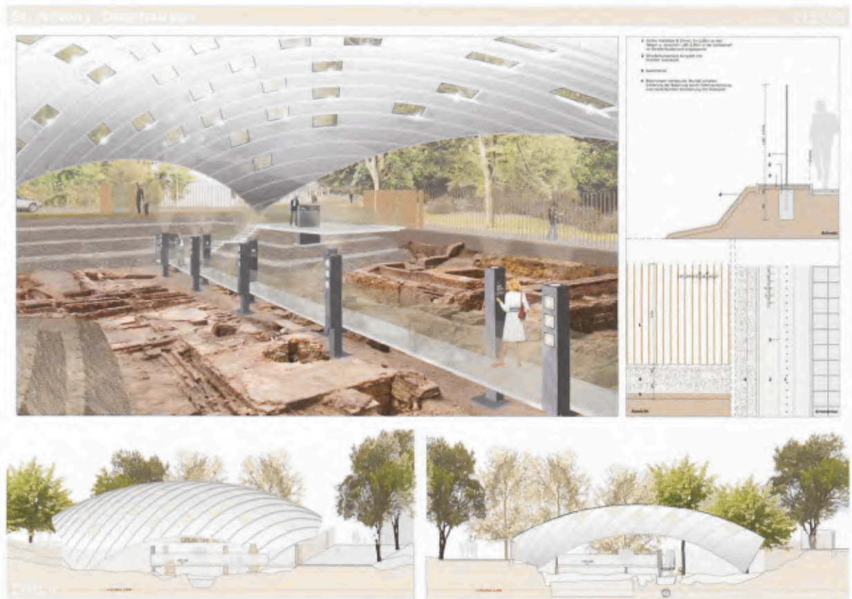
8 Architekturzeichnungen zur Überdachung der industriearchäologischen Grabung, Ansichten-Innenraumgestaltung.
