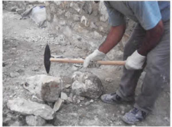
17 Steinbearbeitung mit rekonstruierten römischen Werkzeugen.
