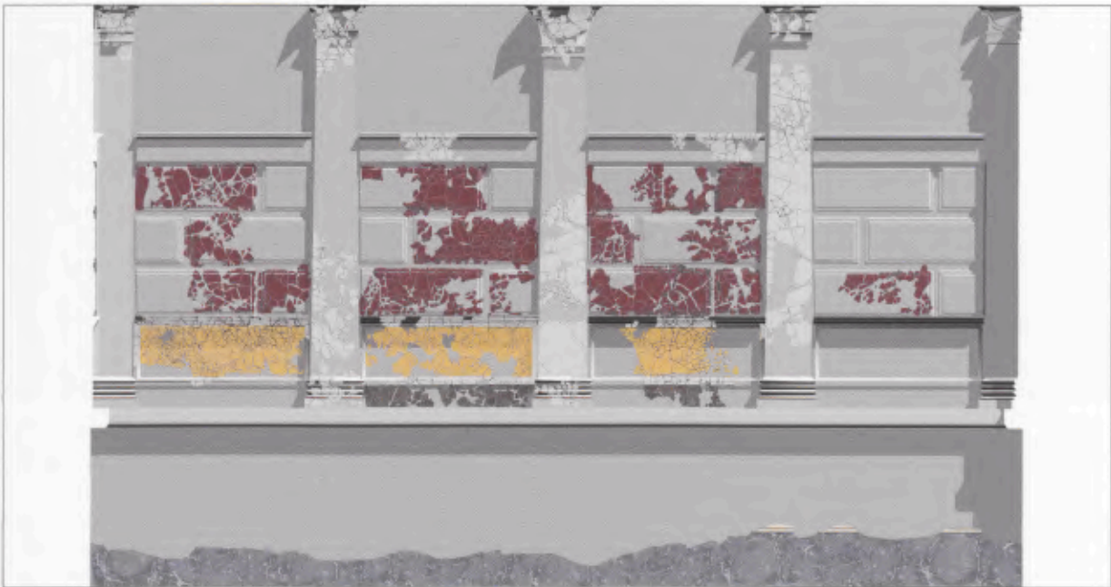
6 Rekonstruktionszeichnung der Stuckdekoration an der Nordwand des Eckraumes mit der Darstellung der erhaltenen Fragmente.
