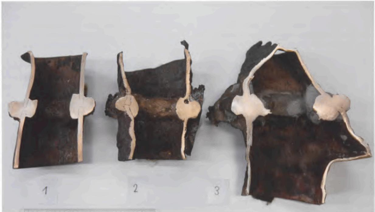
Abb. 14 Xantener Knabe, Experimente zum Angusssschweißen. Schnitt durch die Schweißnähte der drei unterschiedlichen Versuche.
