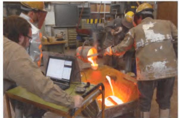
Abb. 23 Xantener Knabe, Experimente zum Angusssschweißen. Gussvorgang mit Temperaturaufzeichnung.
