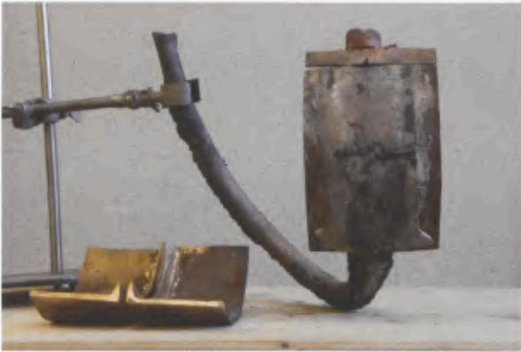
Abb. 24 Xantener Knabe, Experimente zum Anguss-schweißen. Bronzeplatten vor (links) und nach dem Schweißversuch (rechts).
