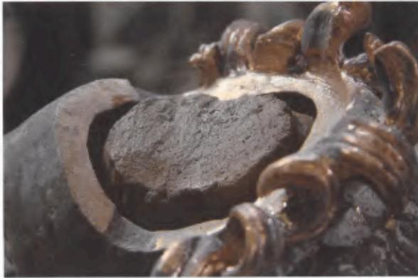
Abb. 17 Xantener Knabe, Experimente zum Angusschweißen. Mit Lehm-Kernmaterial gefüllter Nachguss vom Kopf.
