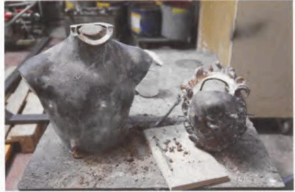
Abb. 18 Xantener Knabe, Experimente zum Angusschweißen. Modellierung des Nahthohlraumes im Kernmaterial des Kopfes und des Halses.
