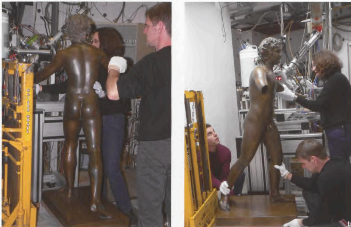
Abb. 9 Xantener Knabe, Messungen zur Metalllegierung. Der experimentelle Aufbau der Statue auf einem Hubtisch, mit der sie vor dem Strahlrohr positioniert werden konnte. a) Der Detektor ist hellgrün. b) Durch die dünne Folie des Austrittsfensters schimmert das Fadenkreuz des Positionierlasers.
