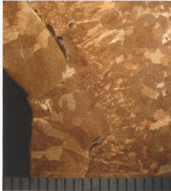
Abb. 20 Xantener Knabe, Experimente zum Anguss-schweißen. Metalllografischer Anschnitt mit Makroätzung. Detail der vollständigen Nahtverschweißung zwischen Kopf und Hals.
