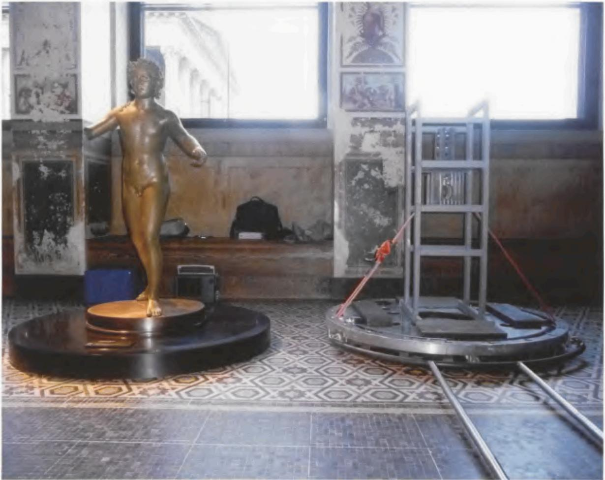
Abb. 33a Xantener Knabe, fahrbarer Sockel. Die Statue auf dem alten Sockel neben dem ‚Rohbau‘ des neuen fahrbaren Sockels einschließlich Deichsel und Ersatzkörper.
