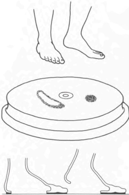
Abb. 23 Römische Versockelungstechnik auf Metallbasen. Charakteristisch sind die offenen Fußsohlen.
